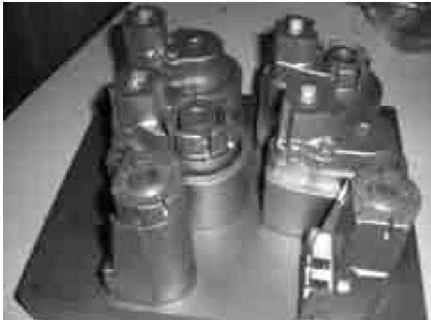
Ilustración 25: Insertos de molde fabricados por sinterizado láser en metal. Cortesía de IMVOLCA, S.L. (PAKTO)
