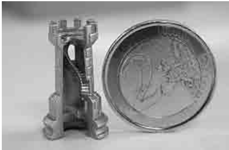
Ilustración 5: Geometría interna compleja en la escalera helicoidal interna de una torre del tamaño de una moneda
