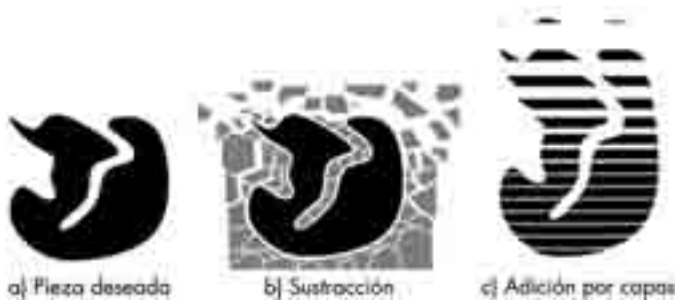
Ilustración 1: Concepto de fabricación sustractiva comparado con AM
