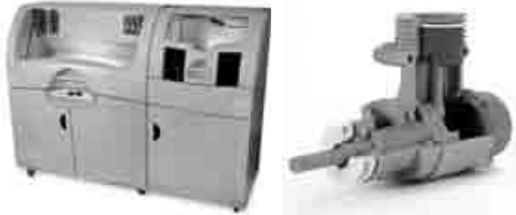
Ilustración 37: Impresora 3D y prototipo a color. Cortesía de Z Corporation
