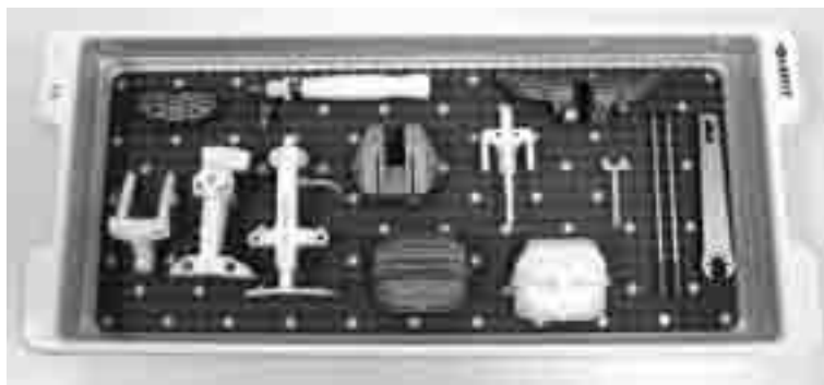
Ilustración 20: Juego de instrumental quirúrgico fabricado mediante estereolitografía en resina 18420 y SLM en acero inoxidable AISI 316L. Cortesía de AIMME, LAFITT
