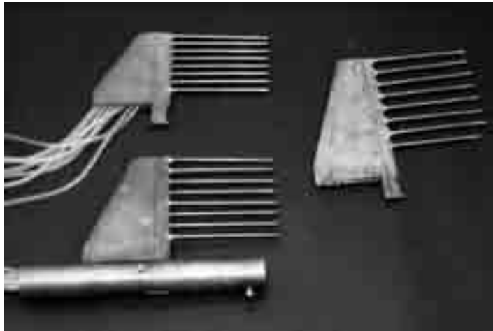
Ilustración 22: Fabricación tradicional de peines de instrumentación rakes . Cortesía de RAMEM
