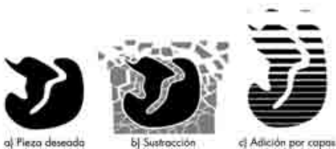
Ilustración 1: Concepto de fabricación sustractiva comparado con AM
