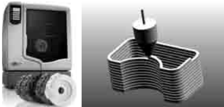
Ilustración 41: FDM máquina con prototipo fabricado y proceso de fabricación. Cortesía de Dimension uPrint
