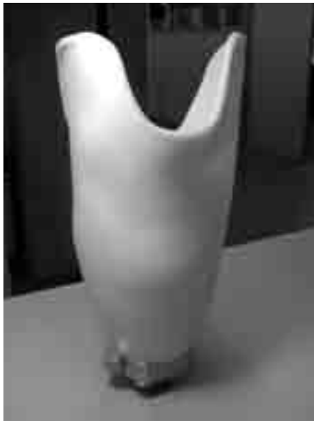
Ilustración 14: Encaje transtibial, resina 18420 SLA. Fuente proyecto FABIO: AIMME, ASCAMM, IBV e INASMET
