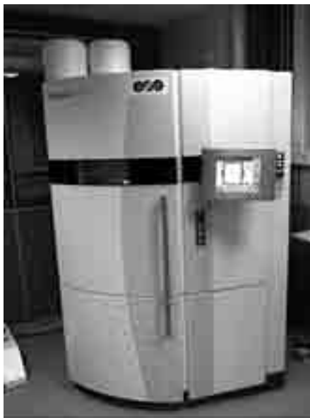
Ilustración 38: Máquina de sinterizado láser en poliamida EOS Formiga en instalaciones de la Fundación Prodiotec
